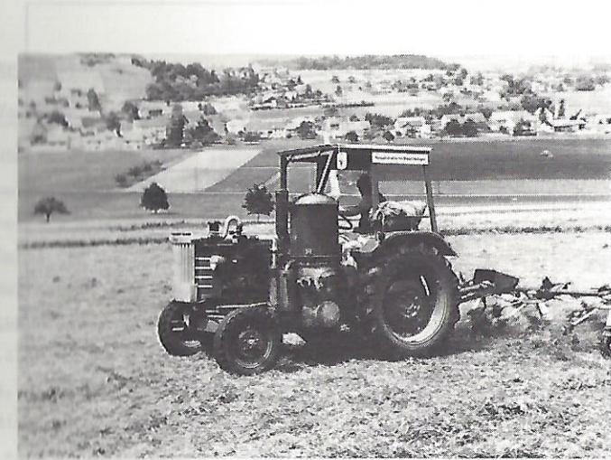
Abb. 8a, 8b + 8c: Der auf Diesel-Holzgas umgebaute Traktor kann für alle üblichen landwirtschaftlichen Einsätze mit einer mehr oder weniger großen Leistungseinbusse eingesetzt werden.
