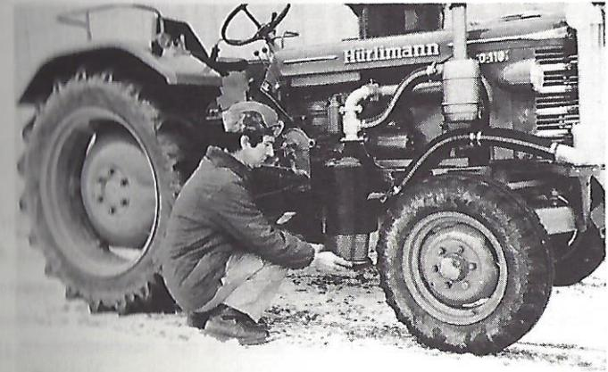
Abb. 161 Der Gasfilter MANN und HUMMEL kann schnell demontiert und zum Reinigen leicht ausgeklopft oder ausgewaschen werden.
