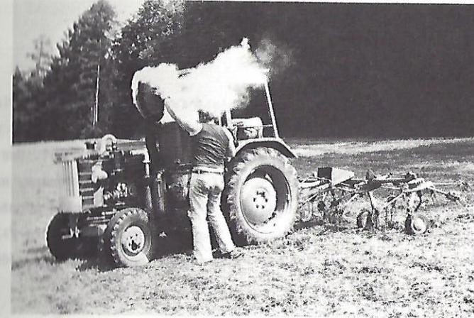
Abb. 9: Das Nachbunkern ist bei laufendem Motor möglich.
