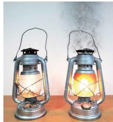
Vereinfachte Demonstration der Verbrennungseigenschaften von konventionellem Diesel (rechts) und Fischer-Tropsch-Diesel (links).
